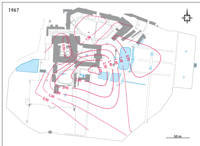
Abb. 6.20 Grundwasser-Flurab- standskarte nach Angaben von SVOBODA (1967)
