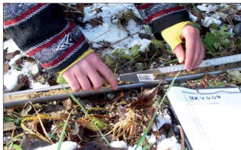
Abb. 4.11, Abb. 4.12 _ Eine Studentin der Geoökologie an der TU Bergakademie Freiberg beschäftigte sich mit den Bodeneigenschaften im Klostergelände. Beim Einrammen des Bohrstocks (oben) und Auswerten der Probe (unten).
