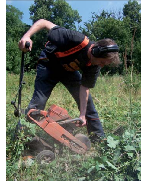
Abb 8.2 _ Auch von professionellen Freiwilligen erhalten die Schüler Unterstützung: Hier werden Stubben gefräst.
