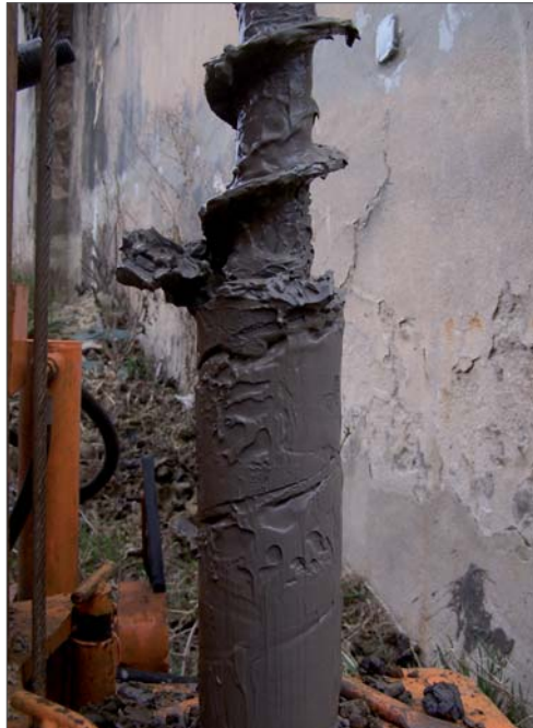
Abb. 4.3 _ Bohrschnecke mit dunklen tertiären Tonen.
