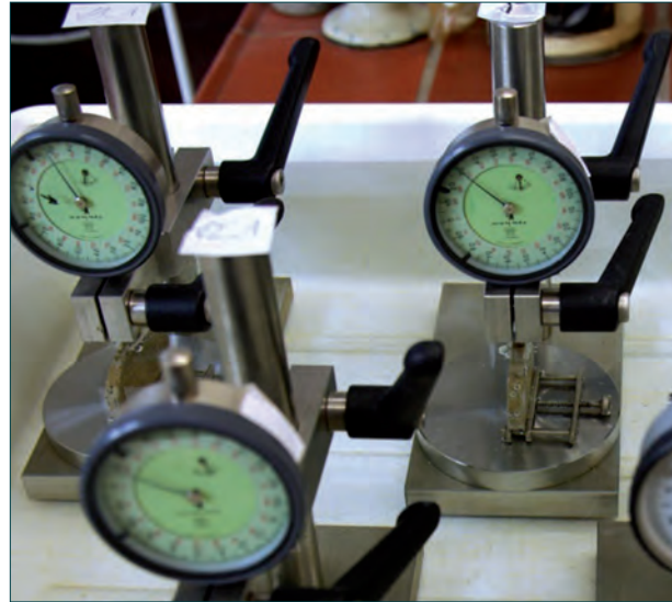
Abb. 35 Messung der hydrischen Dehnung an Bohrkernscheiben.
