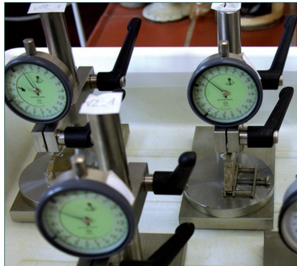
Abb. 35 Messung der hydrischen Dehnung an Bohrkernscheiben.
